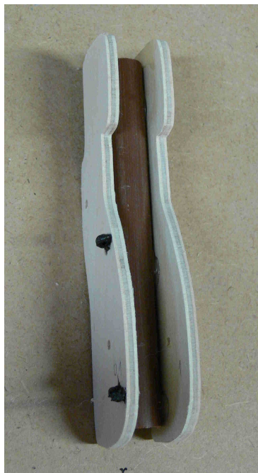
A test oldalpanelei a csőre ragasztva
